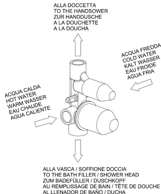
Preparare un foro adeguato nella parete ed inserirvi il miscelatore con la protezione montata (le quote di incasso 51 min. – 66 max. si intendono a parete finita compreso il rivestimento).
